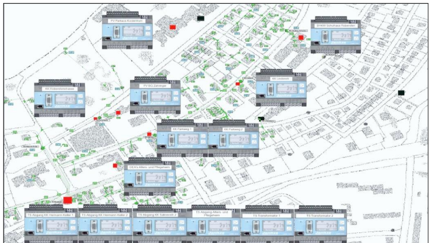
Übersicht über die Platzierung der PQ-Messgeräte im NS-Netz der TS Kreuzmatt
